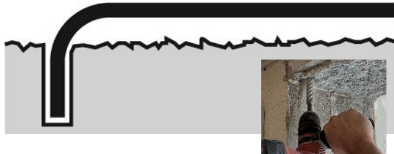
1. Bohren in Beton (Achtung interne Armierung)
