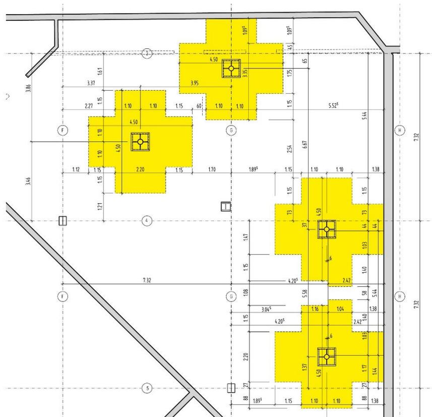
Betonboden eingelassen wurden. Die Stützenköpfe wurden mit externen Stahlpilzen versehen. Auf der Deckenoberseite wurden in diesen Bereichen re-bar 16 Stäbe als vorgespannte Biegezugarmierung eingebaut. In Kombination mit den Stahlpilzen der Stützenköpfe wird so der erforderliche Durchstanzwiderstand erreicht. Zugleich werden auch die neu entstehenden, negativen Biegemomente abgedeckt.
