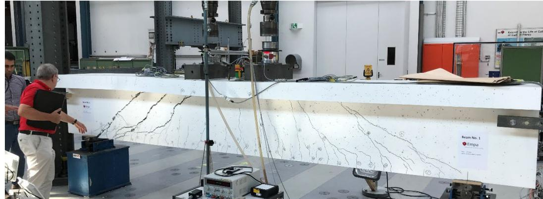
Traglastversuch bis zum Bruch der innenliegenden Schubbügel
