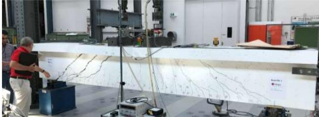
Traglastversuch bis zum Bruch der innenliegenden Schubdügel
