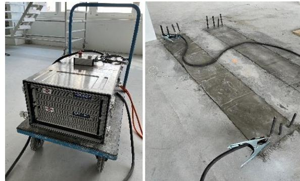
Appareil de chauffage par résistance électrique
