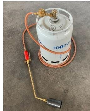
Appareil de chauffage brûleur à gaz
