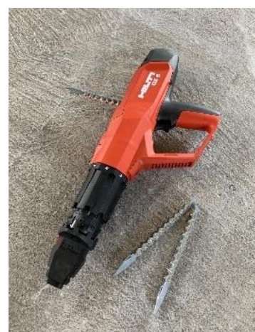
Appareil de pose Hilti pour clous
