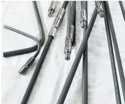
Les barres nervurées memory®-steel re-bar 10 et 16 sont utilisées dans différents domaines de la réparation et maintenance d'ouvrages (pour le béton et la maçonnerie). Les barres d'une longueur maximale de livraison d'environ 5,8 m sont reliées par des coupleurs à vis et installées à la longueur souhaitée. Une fois l'ancrage dans le béton effectué, re-bar est chauffé/précontraint.
