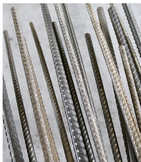
Acier nervuré comparable à un matériau 1.4003 selon la norme DIN EN 10088 (classe de résistance à la corrosion I)
