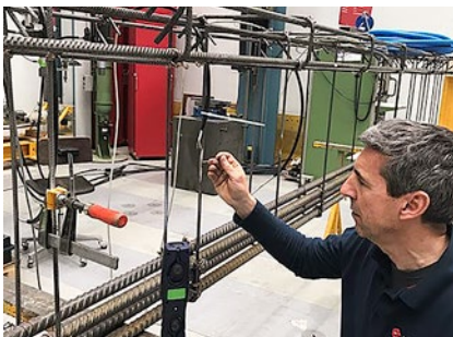
Collage des jauges de contrainte sur les armatures internes
