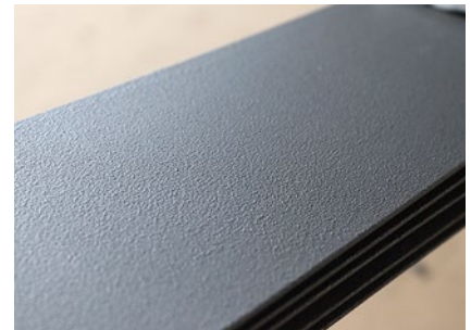
Protection anticorrosion avec SikaCor® EG-1 en usine
