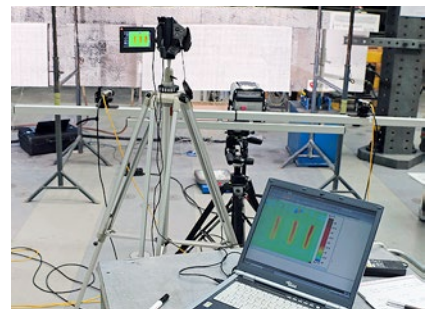
Image thermique des étriers re-bar activés/chauffés
