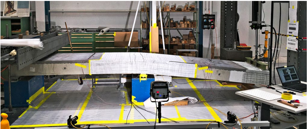
Essai avec dalle en béton à l'Empa
