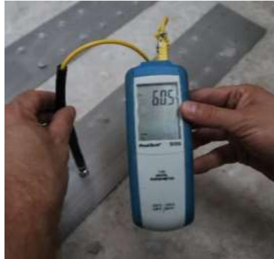
Contrôle température lors du chauffage
