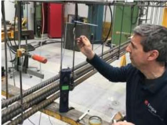
Capteurs de déformation
