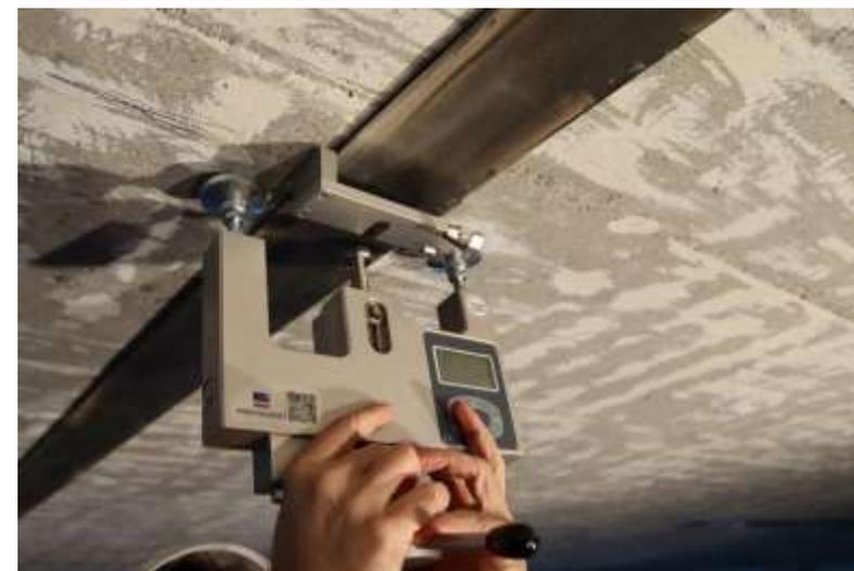
Controllo della precompressione secondo il principio della balestra
