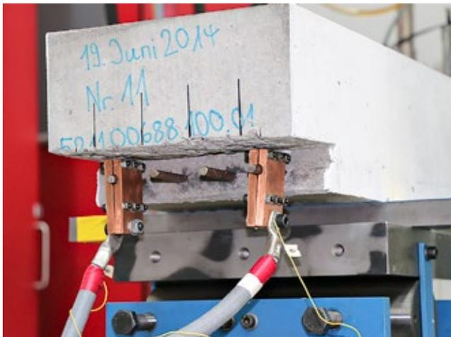
È stato testato il comportamento strutturale del rinforzo con re-bar su un travetto con spessore 160mm, larghezza 250mm e luce 2m. Sono stati confrontati re-bar attivati e non attivati.
