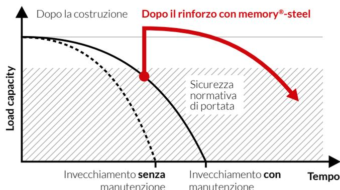
**Dopo il rinforzo il carico continuo dinamico e il rilassamento dell'armatura interna avvengono a un livello di tensione inferiore.**
