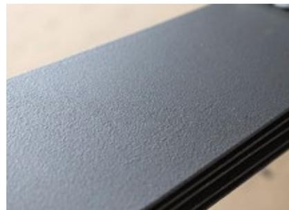
Protezione anticorrosione con SikaCor<sup>®</sup> EG-1 nello stabilimento di produzione
