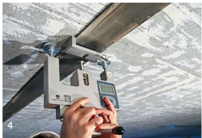
La forza verticale misurata **P** e l'allungamento **d** sono confrontati tramite rapporti trigonometrici delle forze di trazione risultanti nell'elemento di trazione **T + ΔT**.
