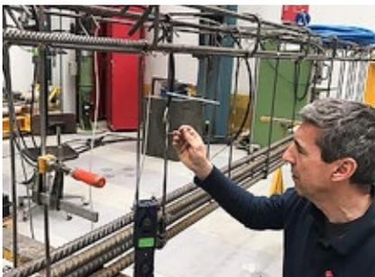
Sull'armatura interna sono stati applicati degli estensimetri
